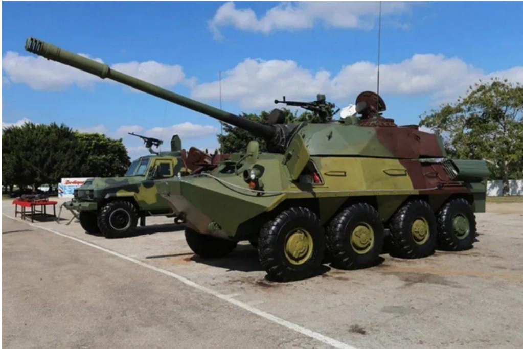
Debido a sus problemas económicos, Cuba recicla su armamento, aquí vemos un injerto entre un vehículo de transporte a ruedas y la torreta de un tanque.
