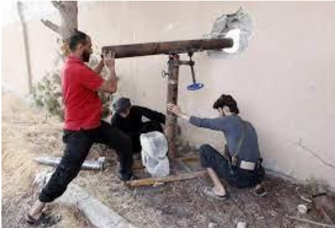
Cañón autopropulsado construido por los rebeldes sirios con base en el cañón de un T-62 ruso, con el tiempo se le habilitó un sistema para evitar que el chasis del cajón absorbiera el retroceso
