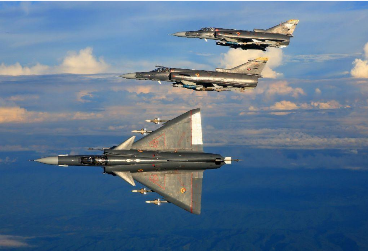
Cazabombarderos IAI Kfir C.10 de la FAC portando misiles aire-aire y bombas guiadas por láser.
