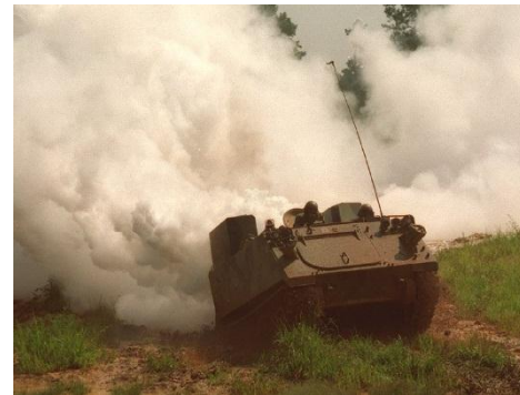
Vehículo M1059 con generador de humo.
